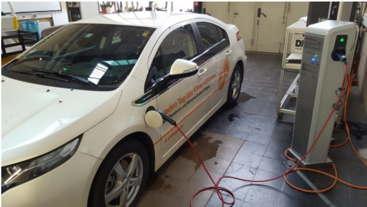
Abb. 3.47: Kompatibilitätstest für gesteuertes Laden am Versuchsstand der TU Darmstadt
