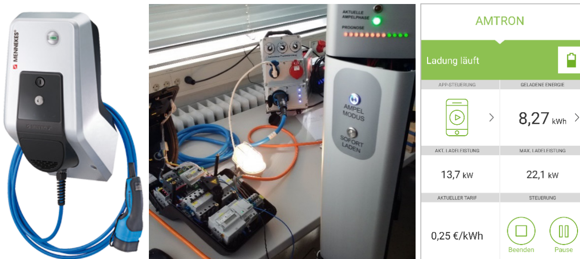
Abb. 3.16: Mennekes Amtron Wallbox (links), Versuchsaufbau zur Ladesteuerung (Mitte), Charging App (rechts)
